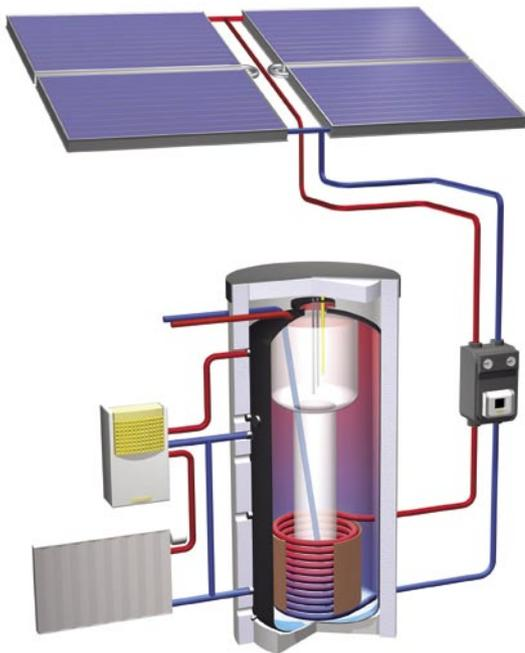
Im Bild ist ein Kombispeicher skizziert, bei dem sich im großen Pufferspeicher außerdem ein kleinerer Trinkwasserspeicher befindet, der seine Wärme aus dem Pufferspeicher erhält. Diese Solaranlage macht also nicht nur das Trinkwasser warm, sie unterstützt auch den Heizkessel bei der Raumheizung, in der Übergangszeit und an sonnigen Wintertagen.
